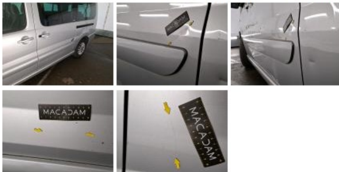
Poignée ext porte ARG, Cassé, E - Remplacer
