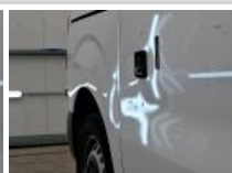
Porte coulissante D, Bosse(s), LI - Réparer et peindre (complet)
