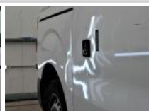
Porte coulissante D, Bosse(s), LI - Réparer et peindre (complet)
