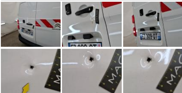
Porte de malle AR G, Trou, LI - Réparer et peindre (complet)
