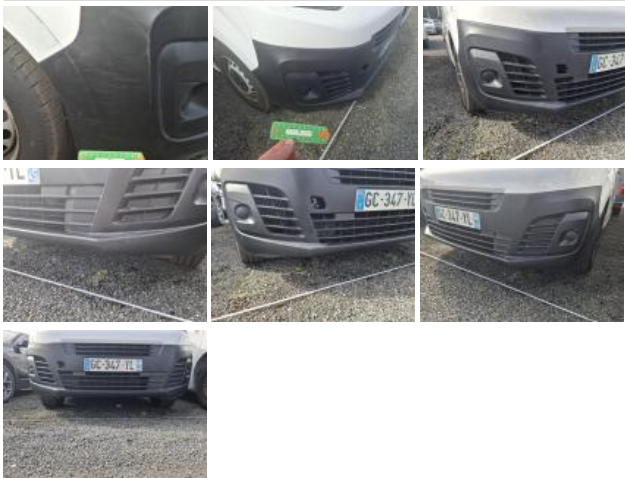
Pare-chocs AV, Déformé / Forcé, Acceptable
