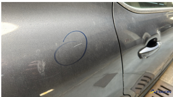
6. parete laterale - posteriore - destra Graffio/Rigature
