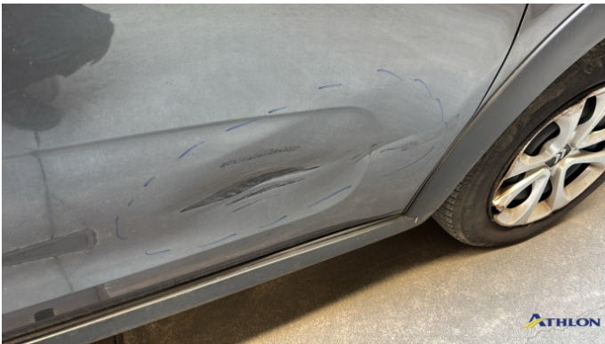
8. porta anteriore - destra 2 ammaccature
