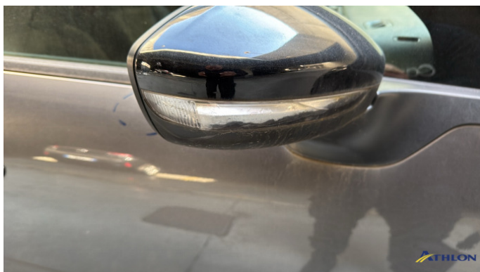
9. retrovisore esterno scatola - destro Rotto
