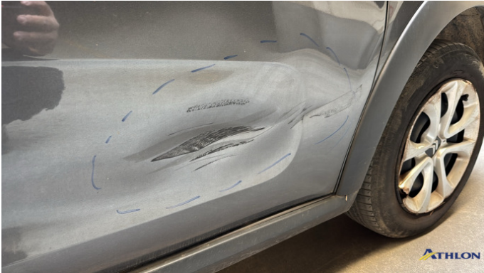
8. porta anteriore - destra 2 ammaccature
