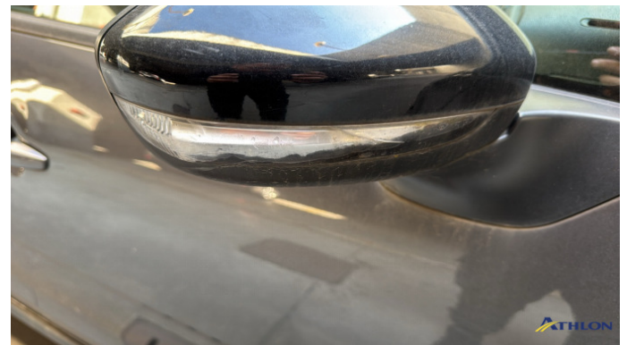
9. retrovisore esterno scatola - destro Rotto
