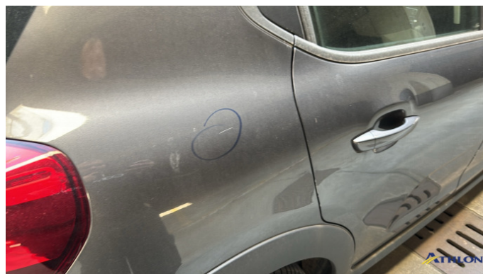
6. parete laterale - posteriore - destra Graffio/Rigature
