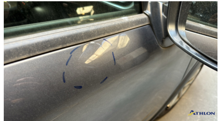
8. porta anteriore - destra 2 ammaccature
