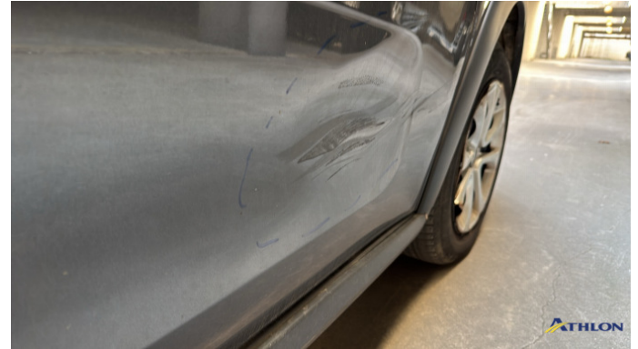
8. porta anteriore - destra 2 ammaccature
