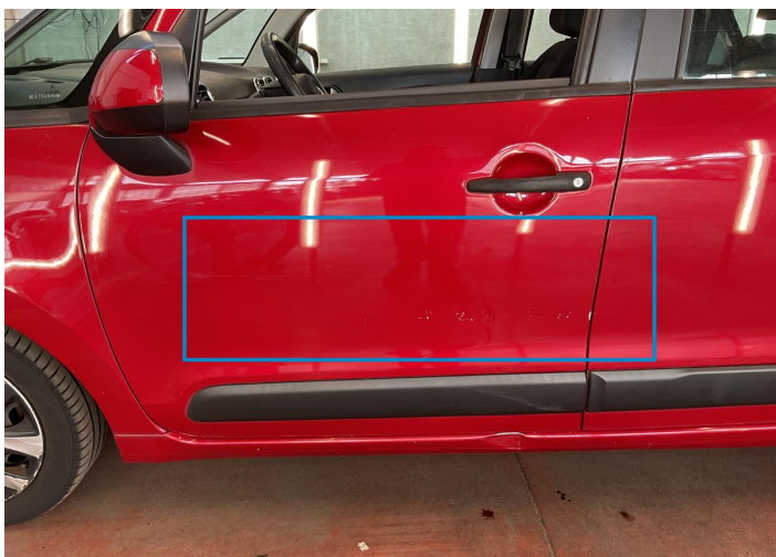
23. Door / Front Left Bodywork / Dent -
