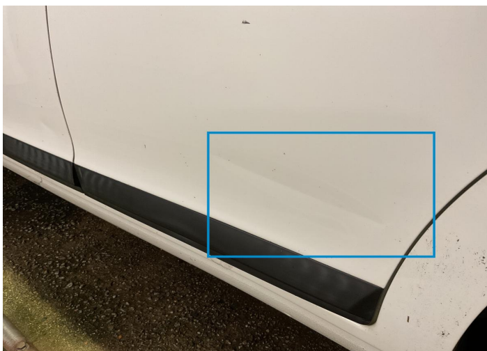
1. Door / Back Left Bodywork / Dent / Dent -
