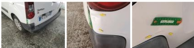
Feu ARG, Cassé, E - Remplacer
