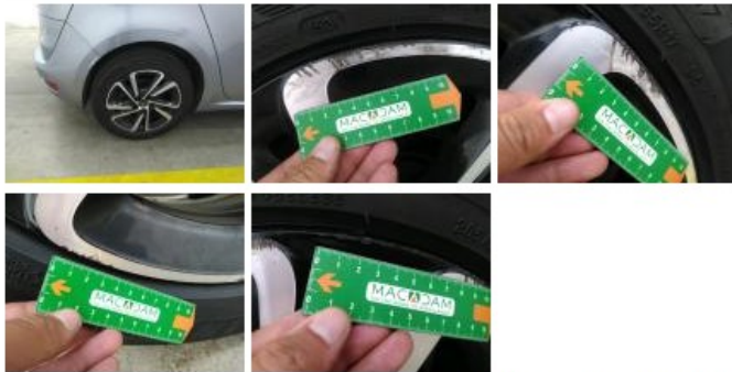
Jante alum. ARG bi-ton/polychrome, Griffe(s), Réparer/rempl. (montant forfaitaire)
