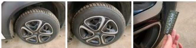
Enjoliveur de roue ARD, Cassé, E - Remplacer
