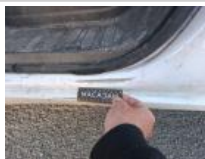
Panneau ARG, Mauvaise réparation, Peindre
