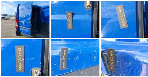
Boot door lining L, Broken, Replace
