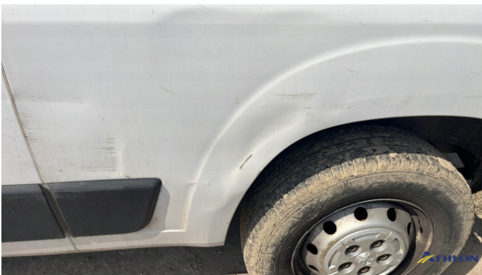
6. parete laterale - posteriore - sinistra Ammaccature/rigonfiamenti
