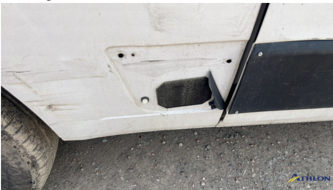
2. parete laterale - posteriore - destra Rotto
