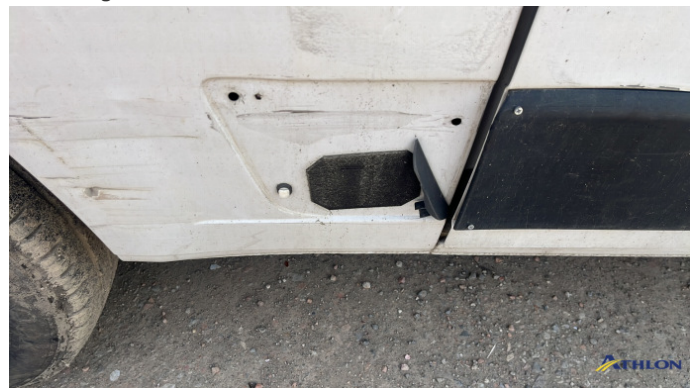
2. parete laterale - posteriore - destra Rotto
