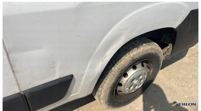
6. parete laterale - posteriore - sinistra Ammaccature/rigonfiamenti
