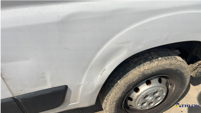
6. parete laterale - posteriore - sinistra Ammaccature/rigonfiamenti
