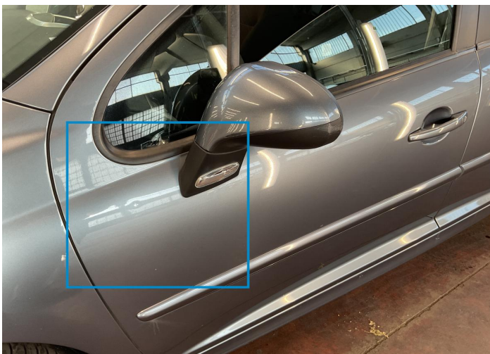
16. Door / Front Left Bodywork / Dent -
