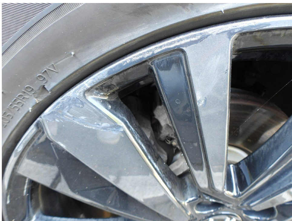
Bild 10 : LM-Felge vorne links, verschrammt
