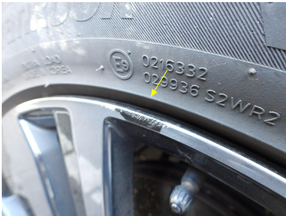
Bild 7 : LM-Felge vorne rechts, verschrammt
