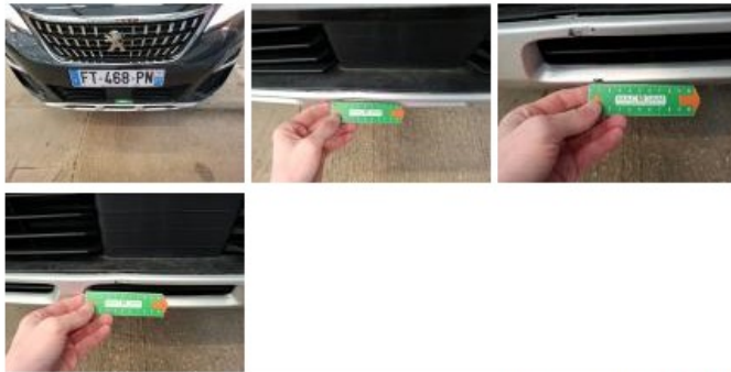
Grille de pare-chocs AV M, Dégrafé, Acceptable
