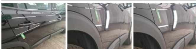
Porte AVD, Bosse(s) et griffe(s), L.L. Réparer et peindre (complet)
