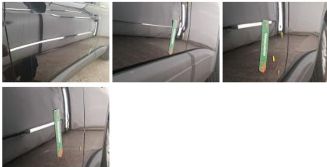
Porte ARG, Mauvaise réparation, Peindre
