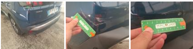
Moulure de pare-chocs AR, Griffe(s), E - Remplacer
