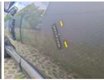
Door trim RL, Scratch(es), Replace
