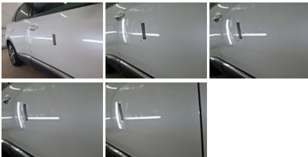
Porte AVD, Mauvaise réparation, Peindre
