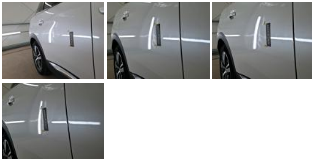
Porte AVD, Mauvaise réparation, Peindre
