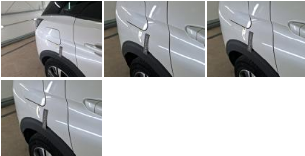
Porte ARD, Mauvaise réparation, Peindre
