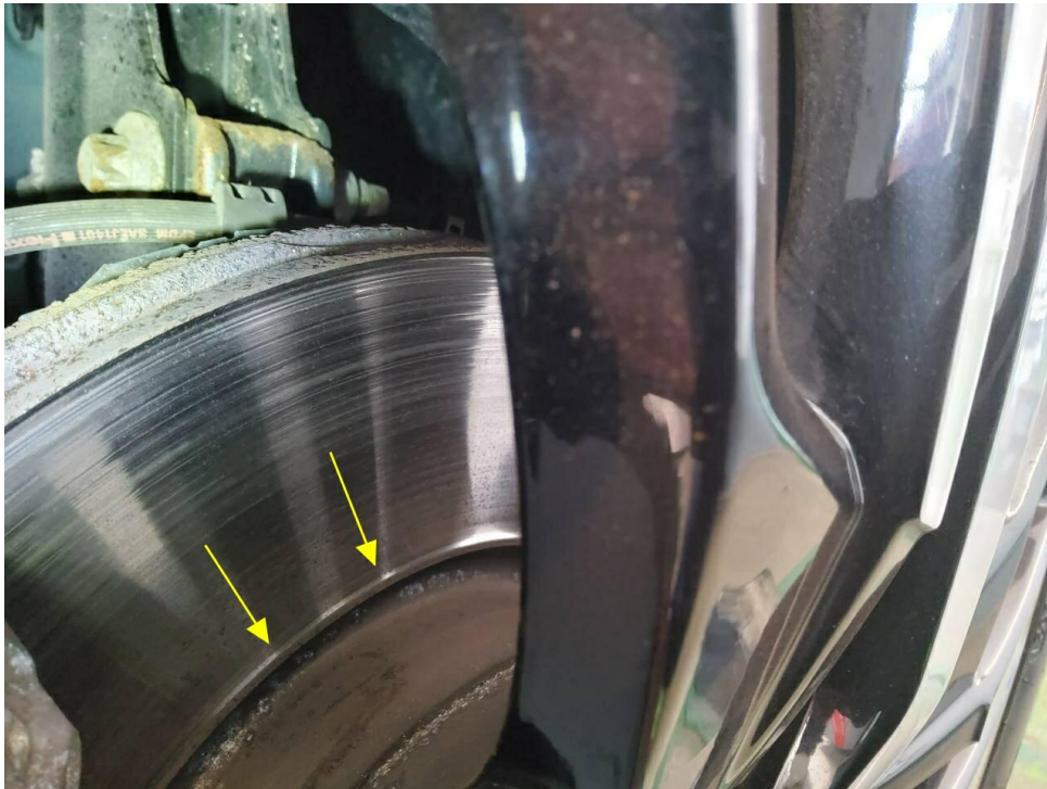
Bild 19 : Bremsscheiben/Beläge vorn verschlissen
