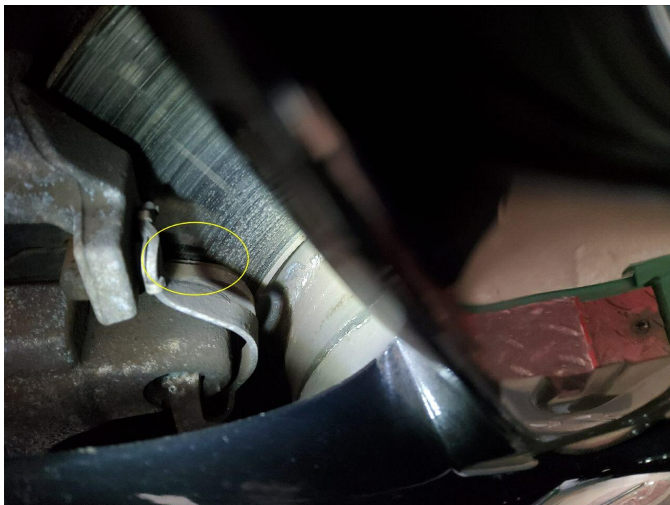
Bild 18 : Bremsscheiben und Beläge vorn verschlissen
