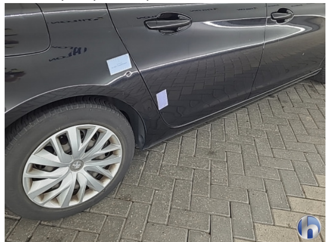
4. Zijwand - achter - rechts Deuk/deuken - Herstellen
