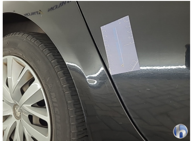
4. Zijwand - achter - rechts Deuk/deuken - Herstellen
