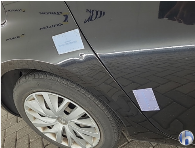
4. Zijwand - achter - rechts Deuk/deuken - Herstellen
