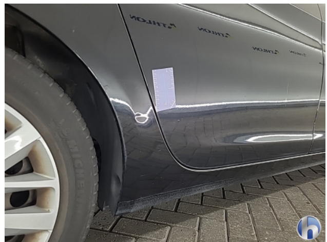
4. Zijwand - achter - rechts Deuk/deuken - Herstellen
