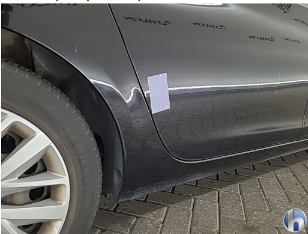
4. Zijwand - achter - rechts Deuk/deuken - Herstellen
