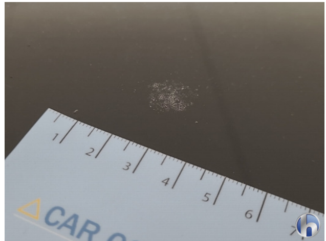
6. Ingebrande vogelpoep Beschadigd - Spuiten
