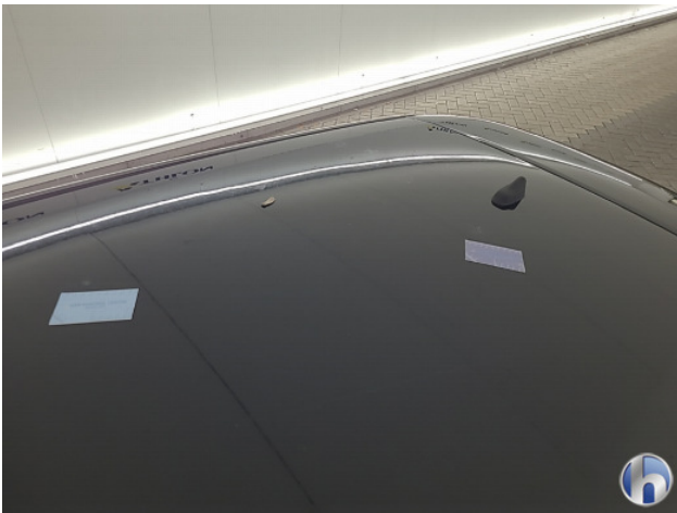
6. Ingebrande vogelpoep Beschadigd - Spuiten
