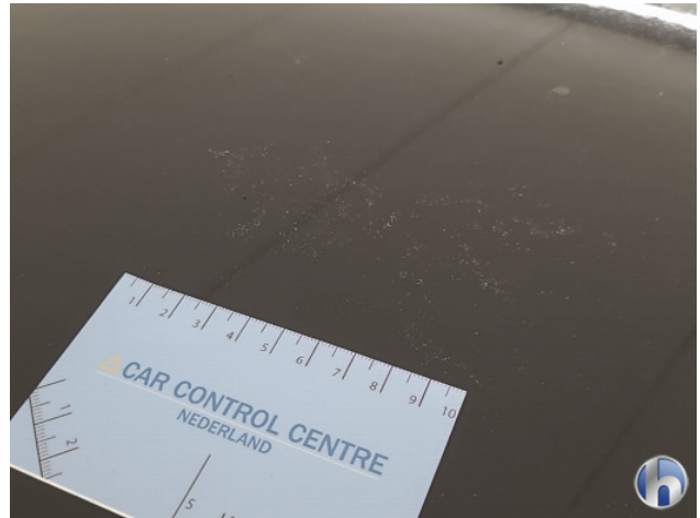
6. Ingebrande vogelpoep Beschadigd - Spuiten
