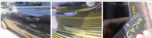
Door FL, Repaired, Check
