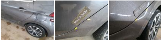
Bas de caisse ext D, Griffe(s), Acceptable
