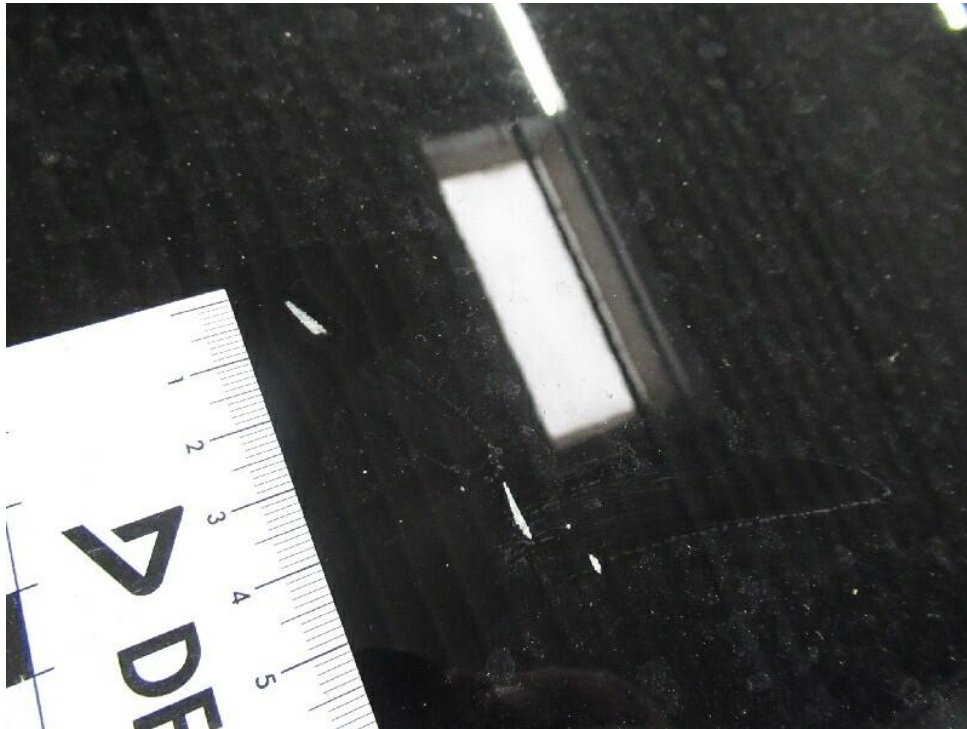
Bild 31 : Motorhaube Lackierung, Steinschlag, lackieren mit Lackaufbau
