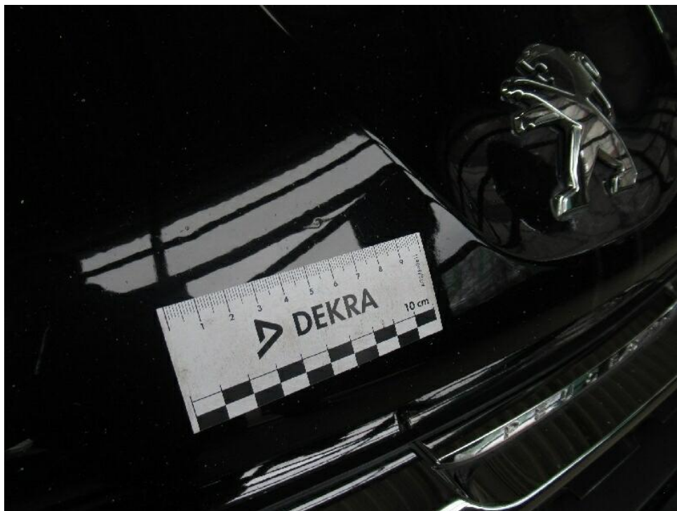
Bild 29 : Motorhaube Lackierung, Steinschlag, lackieren mit Lackaufbau
