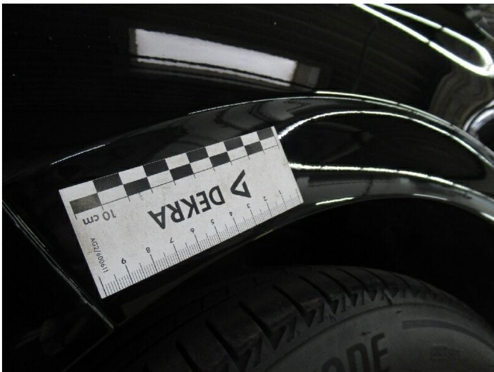
Bild 38 : Kotflügel vorne links Lackierung, zerkratzt, smart repair
