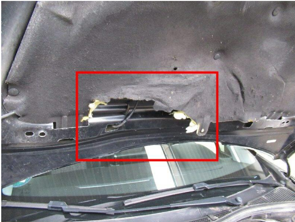
Bild 37 : Motorhaube Dämmung eingerissen
