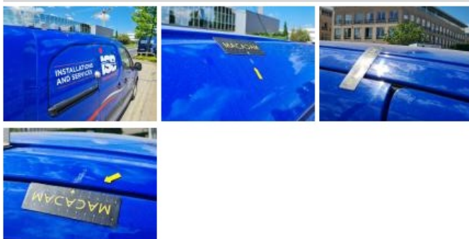
Sliding door R, Scratch(es), Acceptable
