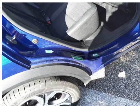
Door sill / Back Right / Dent
