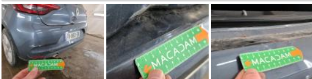
Pare-chocs AR, Déformé / Forcé, Le - Remplacer et peindre
