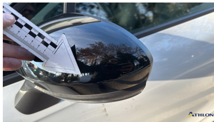
2. retrovisore esterno scatola - sinistro Graffio/Rigature
