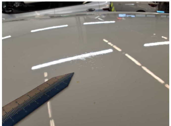
Damage 8: Roof: Roof (Vogelkotverätzung) - Paint defect - Paint
