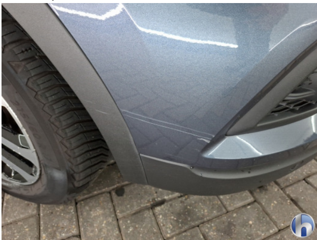
1. Diverse Gebruikssporen - Aanvaardbaar
