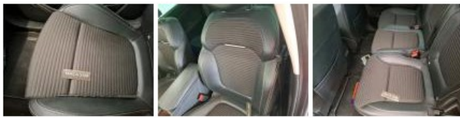
Revêtement assise siège AVG, Déchirure, Smart repair +
