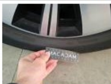
Pneu AVD, Déchirure, E - Remplacer
