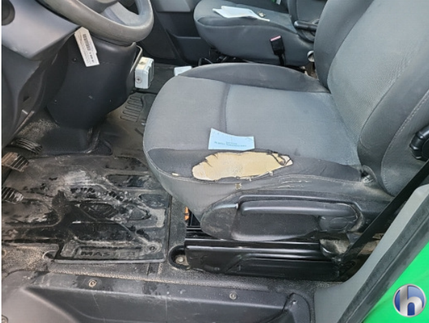
1. meerdere interieur schade Beschadigd - Vernieuwen
