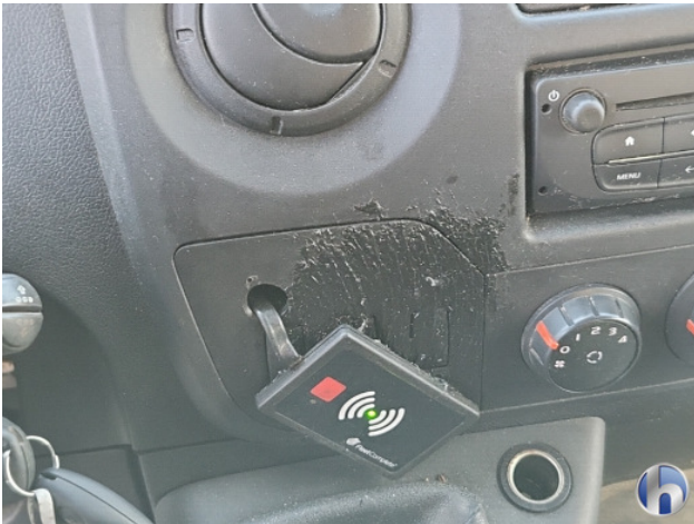
1. meerdere interieur schade Beschadigd - Vernieuwen
