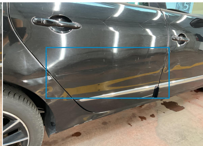
26. Door / Back Right Bodywork / Dent -
