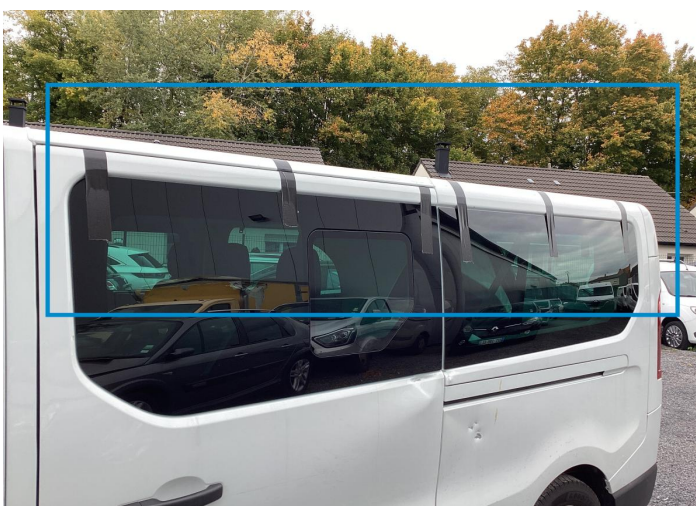
4. Roof Bodywork / Poor Previous Repair - Ruban adhésif ( dégât sous réserve de diagnostic )
