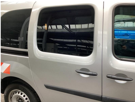
Bild 5: Karosserie / Schiebetür hinten rechts zerkratzt
