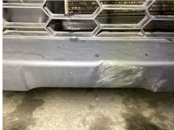
Bild 26: Karosserie / Stoßfänger vorne deformiert
