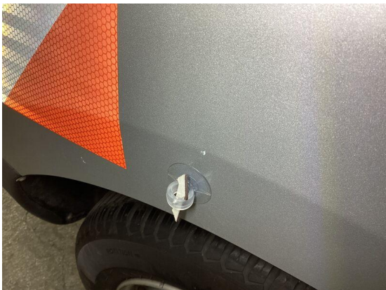
Bild 9: Karosserie / Fondseite rechts leicht deformiert
