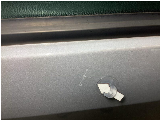
Bild 3: Karosserie / Tür vorne rechts zerkratzt
