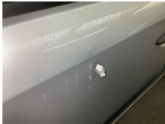
Bild 22: Karosserie / Tür vorne links leicht deformiert
