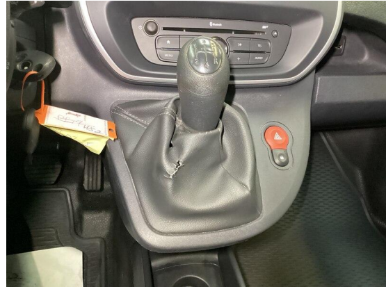
Bild 14: Technik / Schaltmanchette Beschädigt
