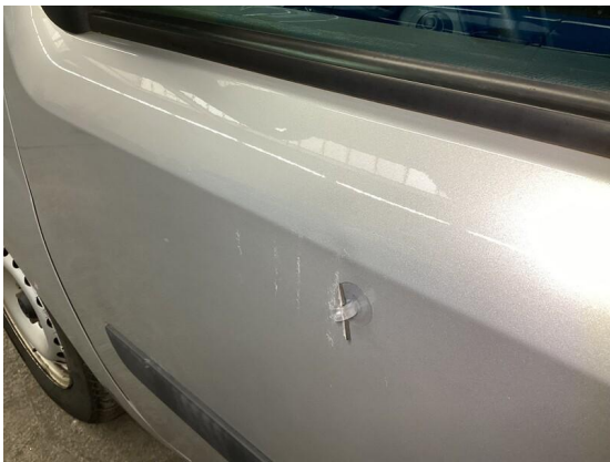
Bild 21: Karosserie / Tür vorne links leicht deformiert
