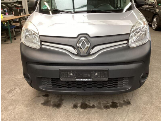
Bild 25: Karosserie / Stoßfänger vorne deformiert
