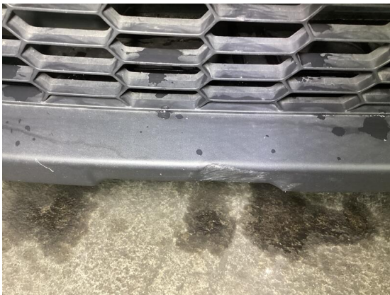
Bild 27: Karosserie / Stoßfänger vorne deformiert
