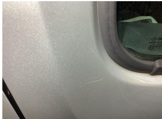
Bild 4: Karosserie / Tür vorne rechts zerkratzt
