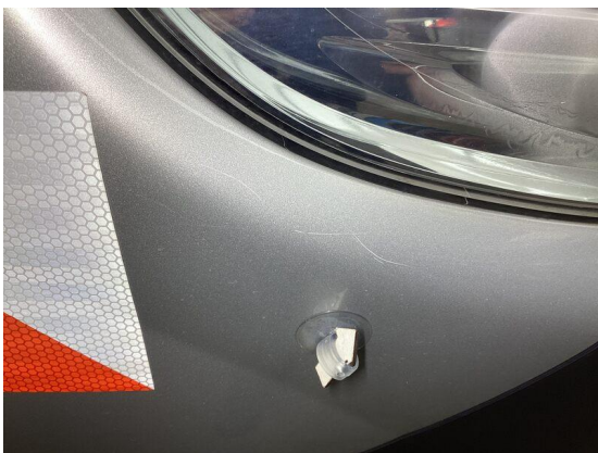
Bild 29: Karosserie / Kotflügel vorne rechts zerkratzt
