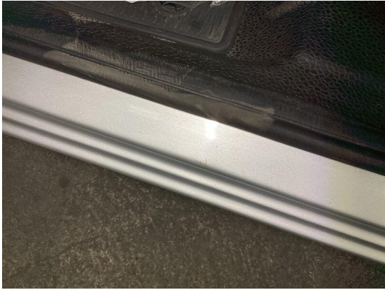
Bild 19: Karosserie / Einstieg vorne links Innenschweller verkratzt
