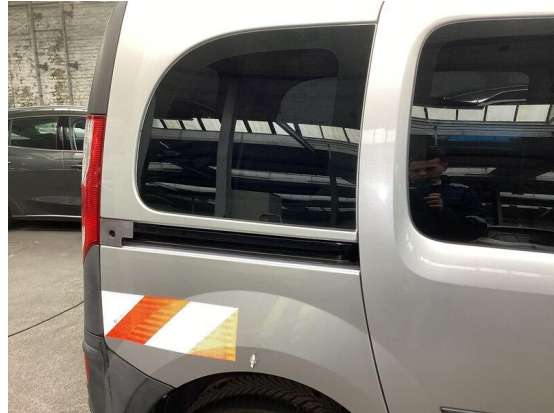
Bild 8: Karosserie / Fondseite rechts leicht deformiert
