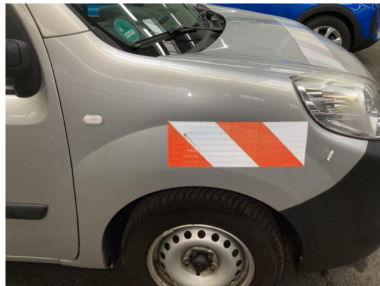
Bild 28: Karosserie / Kotflügel vorne rechts zerkratzt
