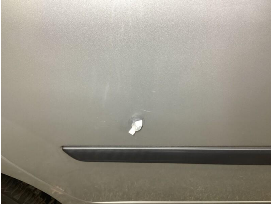
Bild 7: Karosserie / Schiebetür hinten rechts zerkratzt
