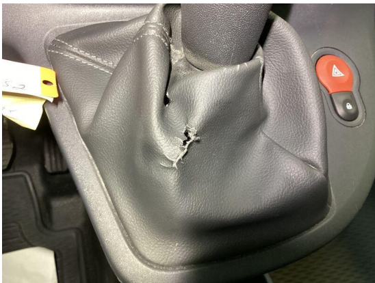
Bild 15: Technik / Schaltmanchette Beschädigt
