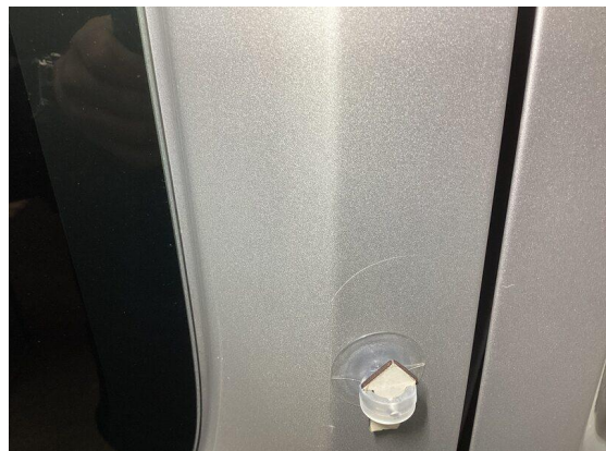
Bild 6: Karosserie / Schiebetür hinten rechts zerkratzt
