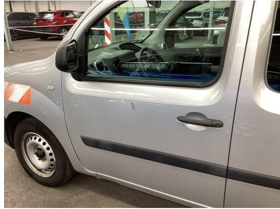
Bild 20: Karosserie / Tür vorne links leicht deformiert
