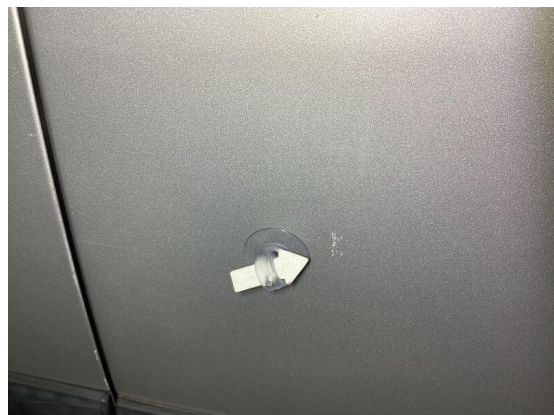
Bild 12: Karosserie / Fondseite links zerkratzt
