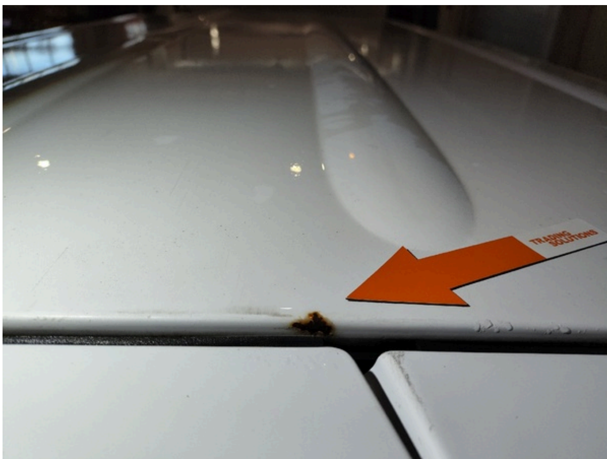
Tak Tak Repor under 3 cm Rostfläck samt rostprickar vid vindrutan överkant 800 kr
