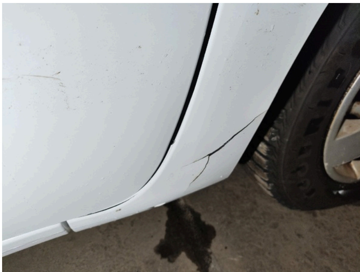
Skärm Höger fram Bucklor 3-10 cm Sprickor 3 500 kr
