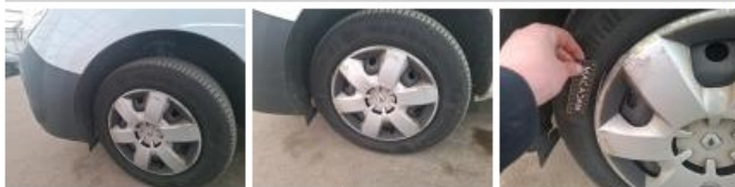
Protect. pass. roue AVG, Cassé, E - Remplacer
