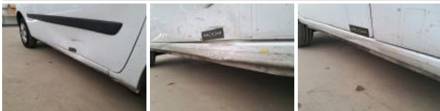
Moulure porte AVD, Déformé / Forcé, E - Remplacer
