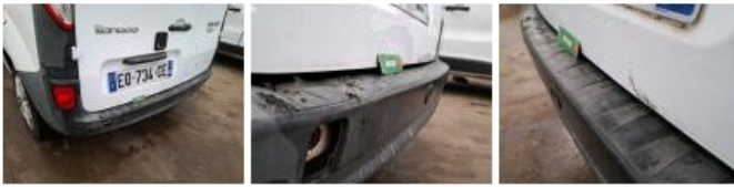
Feu antibrouillard ARG, Cassé, E - Remplacer
