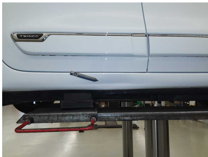
Beschädigung 5: Schweller rechts: Schweller - Delle(n) - instandsetzen und lackieren
