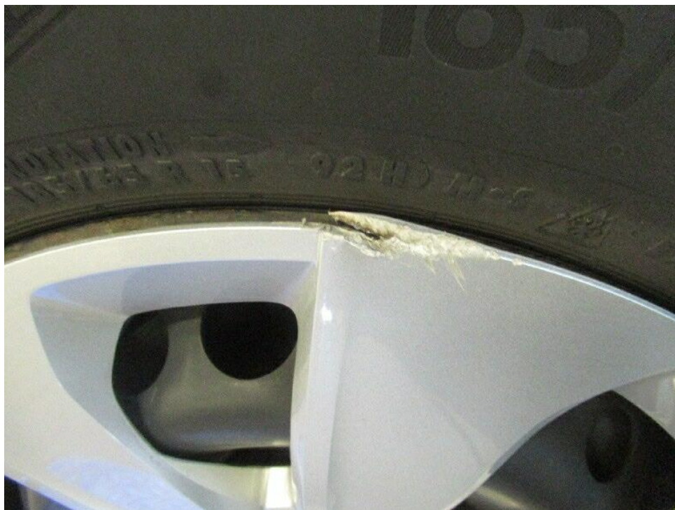
Bild 9 : Felge vorne rechts Radzierdeckel, zerbrochen, erneuern
