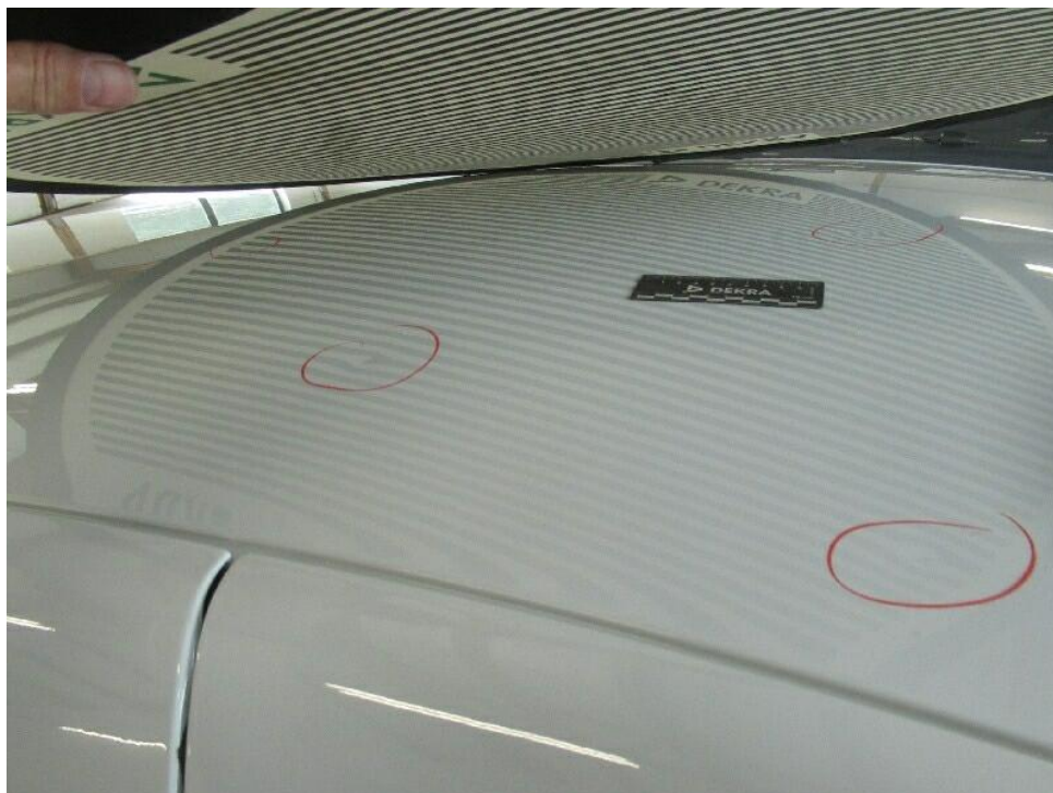
Bild 8 : Dach mehrfach eingedellt, smart repair
