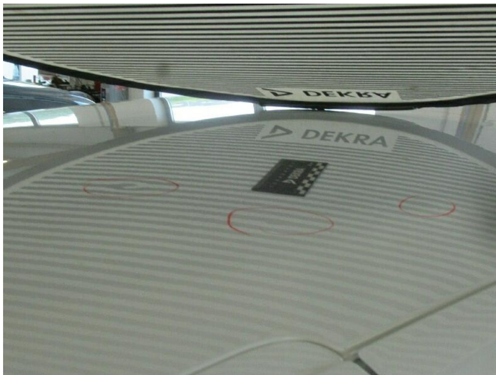
Bild 7 : Dach mehrfach eingedellt, smart repair
