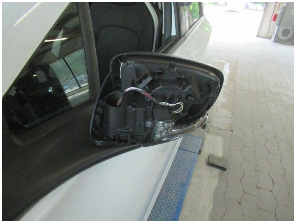
Bild 6 : Kappe Außenspiegel links fehlt, ersetzen
