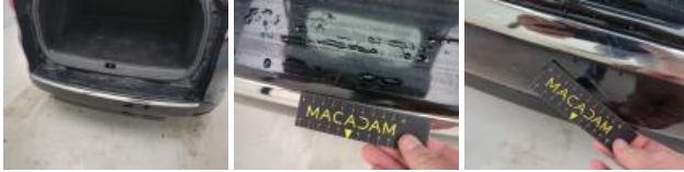
Bumper A sierlijst, Gebroken, Vervangen
