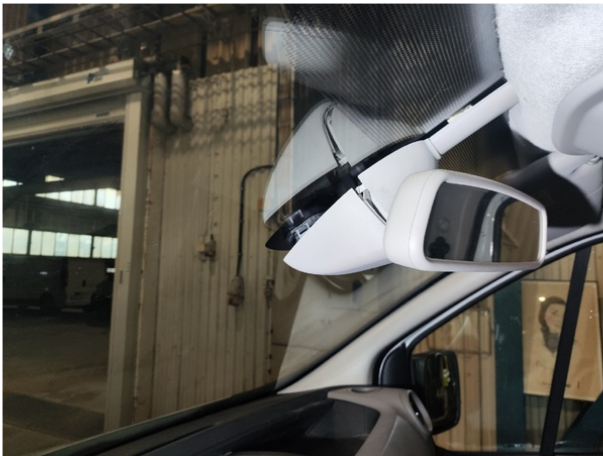
Övrigt Övrigt Övrigt Plastdel till backspegel defekt
