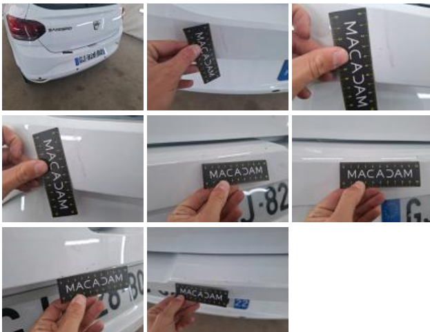
Pare-chocs AR, Mauvaise réparation, Peindre
