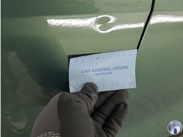
1. Portier voor - links Deuk/deuken - Aanvaardbaar
