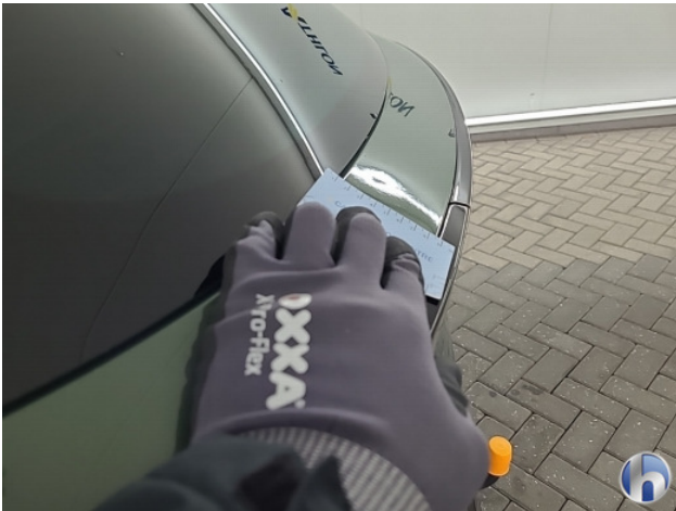
2. Achterklep Deuk/deuken - Aanvaardbaar
