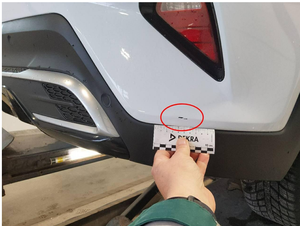
Bild 11 : Stoßfänger hinten, verschrammt, Gebrauchsspur
