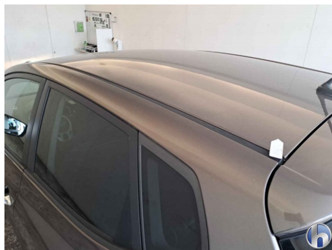
29. Dach mit 60 Dellen à 20-25mm
