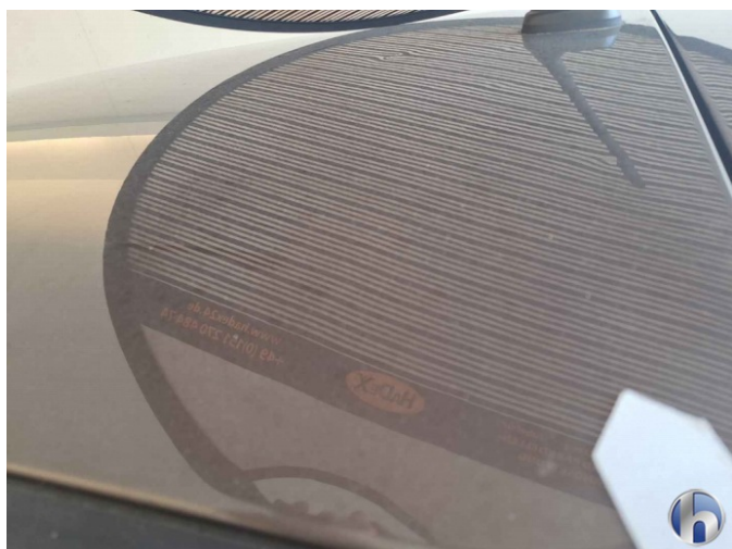
29. Dach mit 60 Dellen à 20-25mm
