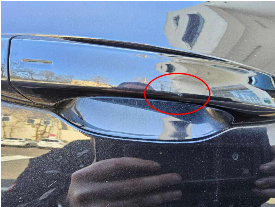
Bild 13 : Tür vorne rechts Türgriff, zerkratzt, lackieren
