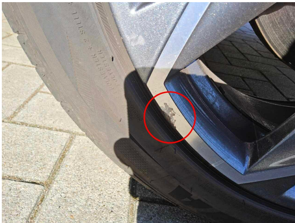
Bild 17 : Alufelge vorn links verschrammt (glanzgedreht)
