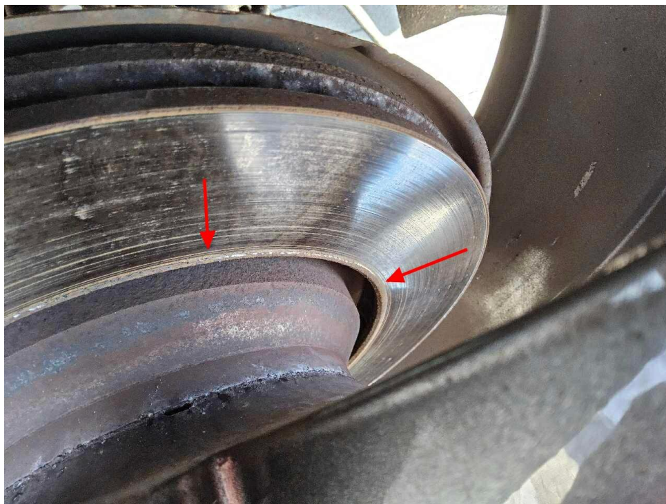
Bild 18 : Bremsscheiben 2. Achse eingelaufen
