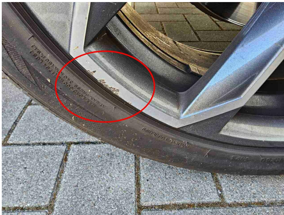
Bild 16 : Alufelge vorn rechts verschrammt (glanzgedreht)
