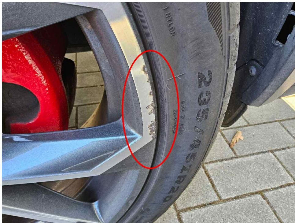
Bild 15 : Alufelge vorn rechts verschrammt (glanzgedreht)
