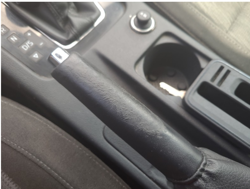
27 Ovládací páka ruční brzdy - Opotřebení Umístění: Interiér (vnitřní prostor)
